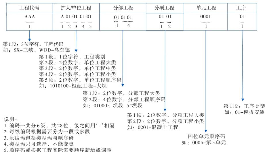
图3 智能建造工程数据编码的结构分解编码体系
