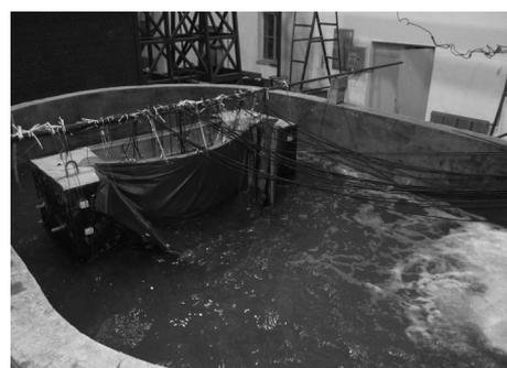
图2 加库水的拱坝试验模型
