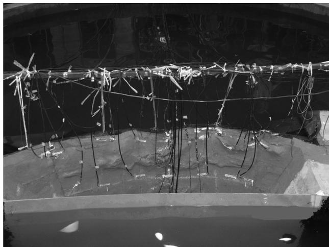
图9 拱坝模型下游面顶拱损伤破坏图
