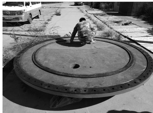
(b) 法兰盘上安装的橡胶条
