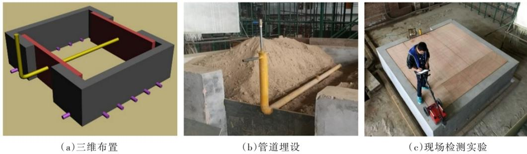
图2 管道泄漏雷达检测实验平台
